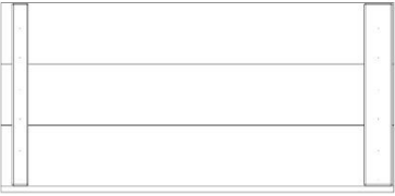
RP5 | PANNEAU DE TOITURE EN PORCHE DROITE - W2A03146 (x1) | 1 5/8 "x15 5/8" x32 7/8 "(42x396x834)
